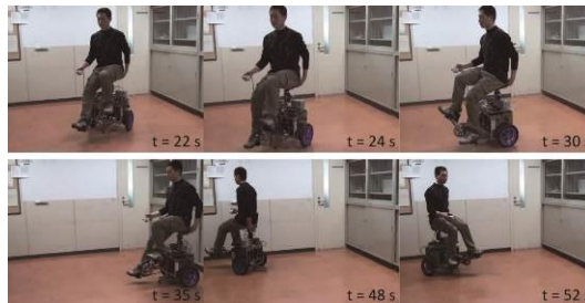
2 自由度車輪角制御機構KMM73の動作実験.
